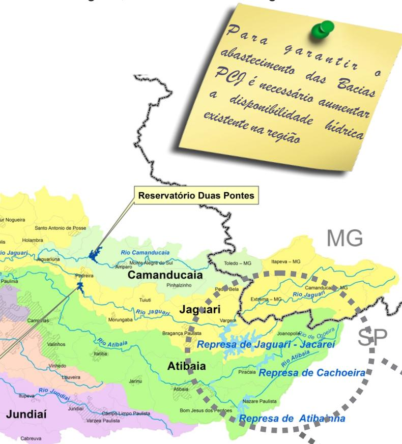
Assim, o sistema garante uma vazão de no mínimo 5m<sup>3</sup>/s para as bacias PCJ, diminuindo a vazão revertida para o Sistema Cantareira, quando necessário.
