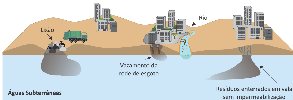
Figura 2.3 - Fontes potenciais de contaminação por nitrato nas águas subterrâneas em áreas urbanas.
