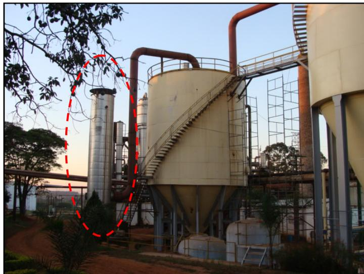
Figura 24 – Coluna de lavagem de gases da fermentação
