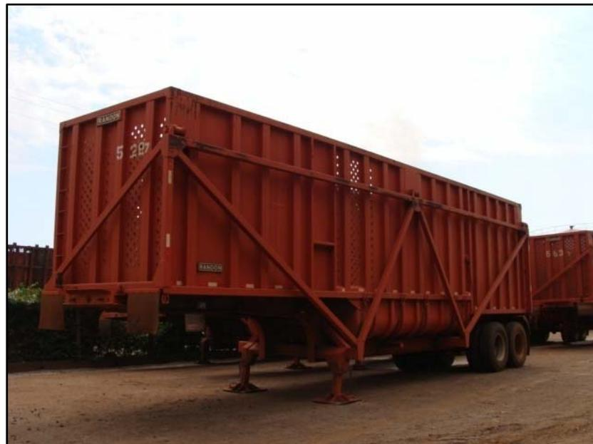
Figura 100 - Gaiola para transporte de cana picada
