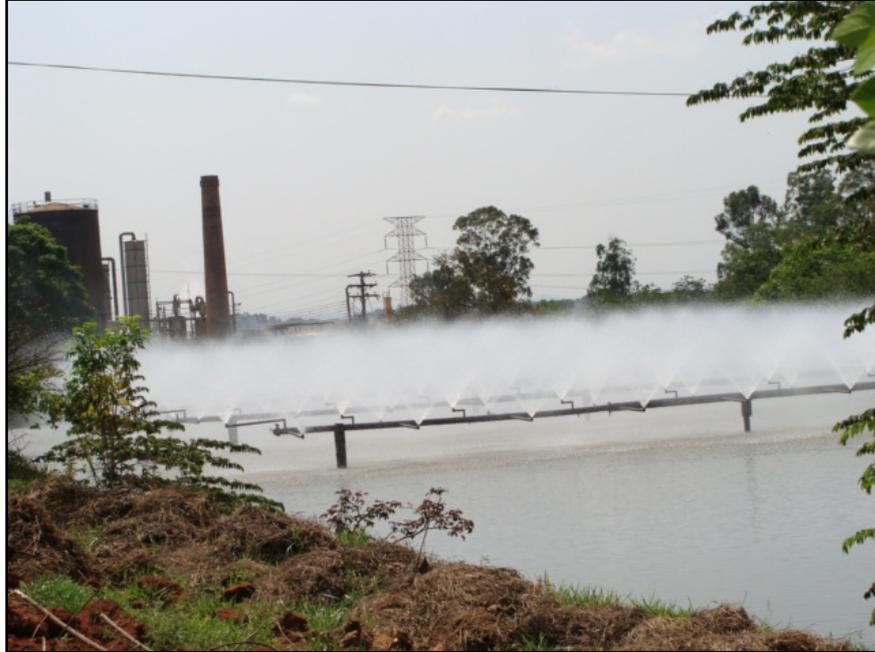
Figura 98 - Aspersor das águas da destilaria.
