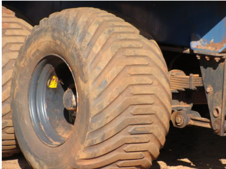
Figura 91 – Pneu especial para reduzir compactação
